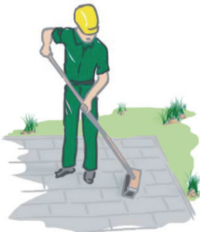
Fugenmaterial (z. B. trockener Sand) nach dem Rütteln einfege
