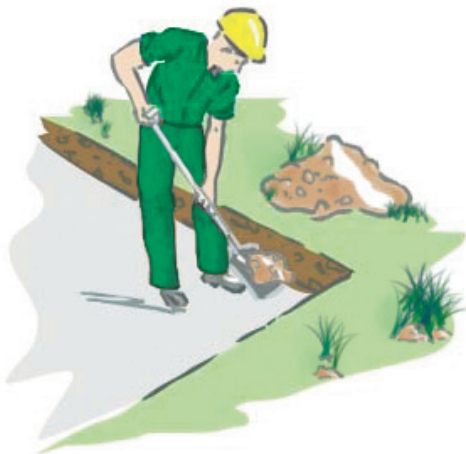
Nicht tragfähige Bodenschichten abgraben
